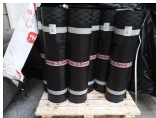
Membrana asfáltica Technicol Technobit APP FP 3.50 mm color rojo. (Vista exterior).
